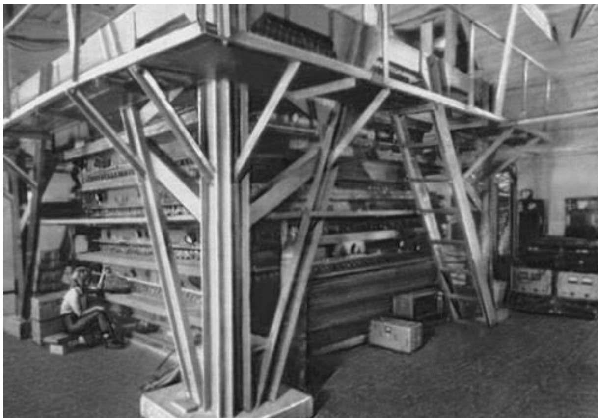
Рисунок 1.4 – Ионизационный калориметр, применяемый на высокогорной станции космических лучей на г. Арагац (Армения) [71]
